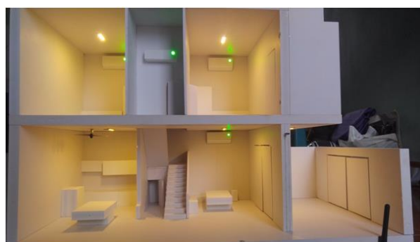
Mô hình điều khiển thiết bị gia dụng trong gia đình sử dụng Vi điều khiển Arduino UNO sản phẩm (sinh viên Điện tử viễn thông)
